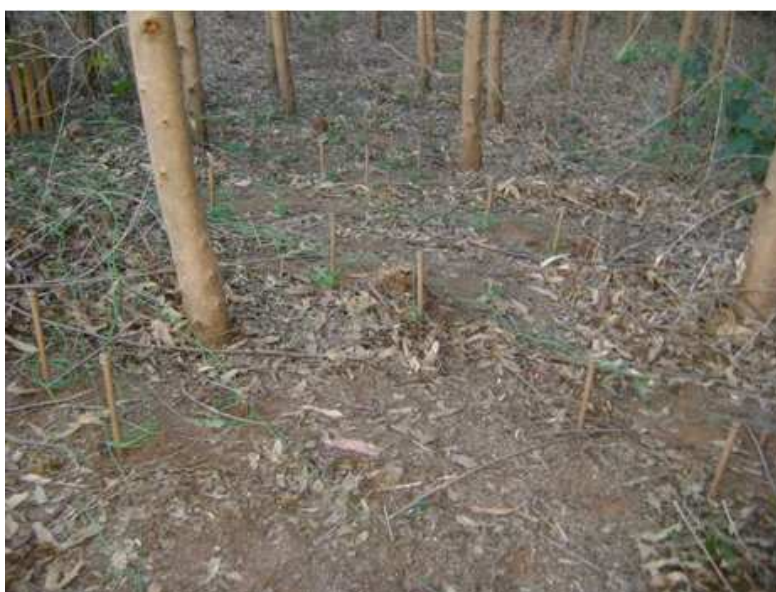
Figura 1: Detalhe da parcela de eucalipto mostrando os sensores Watermark instalados.
